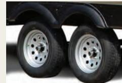
Roues en métal de couleur gris avec essieux Super Lube et contour des ailes en ABS.
