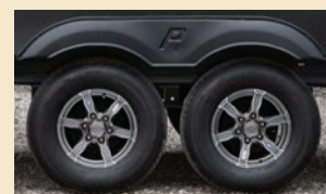
Les roues en aluminium son optionnel. De série inclut: essieux Super Lube, contour des ailes en ABS et des pneus Lionshead remplis au nitrogène pour une sécurité, une durée de vie des pneus et une économie de carburant améliorées.
