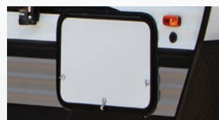
Portes de coffre arrondies et scellées à la silicone pour protéger des éléments
