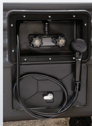
Douche extérieure avec eau chaude et froide
