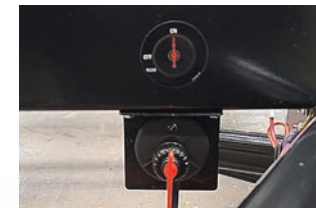
Le sectionneur de batterie Seaflo contrôle la consommation d'énergie. Fonctionne par clé amovible
