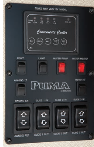
Le centre de commodité affiche les capacités de la batterie/des réservoirs. Contrôle les extensions, l'auvent, les lumières intérieures/porche, pompe à eau/chauffage
